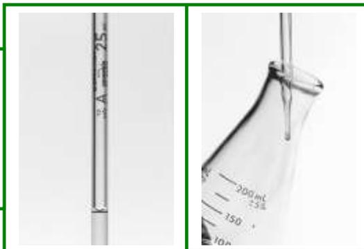
Geralmente a amostra é transferida para o Erlenmeyer de boca larga utilizando-se uma pipeta volumétrica.
