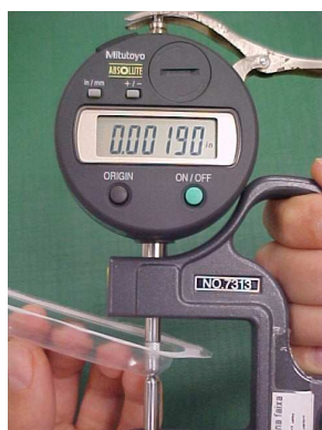
Figura 13 – Medição da espessura Fonte: Autor
