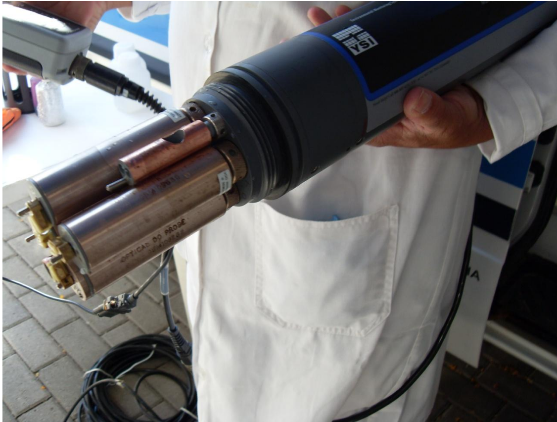
Figura 1 – Sonda multiparâmetro para leitura simultânea de parâmetros (por exemplo, pH, oxigênio dissolvido, condutividade elétrica, temperatura, turbidez) que medem a qualidade de águas superficiais em rios, lagoas, represas e de águas subterrâneas.
