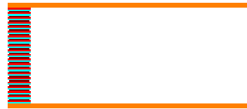
Fig. 9.4.4 Circuito com uma pilha voltaica ligada num arame fino através de duas barras condutores. Por onde flui a energia?
