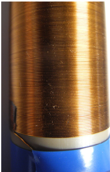
Fig. 7.2.5 Solenoide formado por um arame de cobre envernizado densamente enrolado num tubo de PVC.
