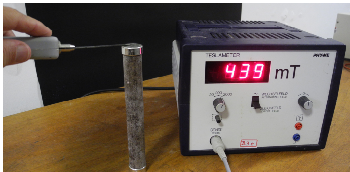
Fig.6.7.8 Medida do campo magnético na superfície de um ímã permanente.
