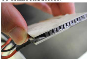
Fig. 5.4.10 Bateria de termopares.
