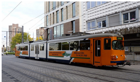
Fig. 4.9.3 Veículo elétrico do transporte público em Mannheim (Alemanha) que usa supercapacitores no teto para armazenar a energia disponível durante a desaceleração. Imagem da Wikipedia.
