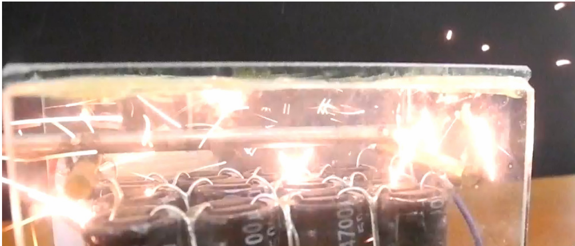
Fig. 4.1.9 Fotografia do momento de descarga do capacitor da figura 4.1.8. A voltagem do capacitor era aproximadamente 180 V. Alguns dos clarões na imagem são reflexos nos vidros. A faísca é o clarão forte no lado direito. Aparecem também gotas de metal derretido.
