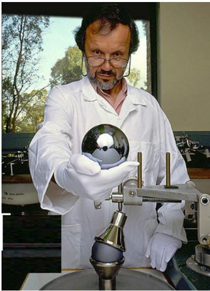
Fig. 3 Esfera de 1 kg de silício puro e mono cristalino para determinação do número de Avogadro no Australian Centre for Precision Optics. (Imagem da Wikipedia).
