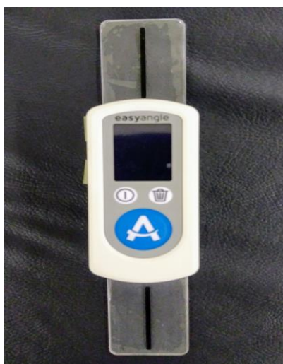
Figura 4: Goniômetro Digital EasyAngle®
