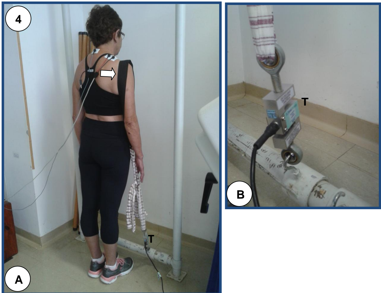
Figura 4 – A. Cinturão de algodão colocado por cima do acrômio do membro superior dominante dos indivíduos (seta), conectado ao tensiômetro (T) da EMG-System utilizado para a coleta dos dados. B. Tensiômetro cujo cinturão de algodão é acoplado.
