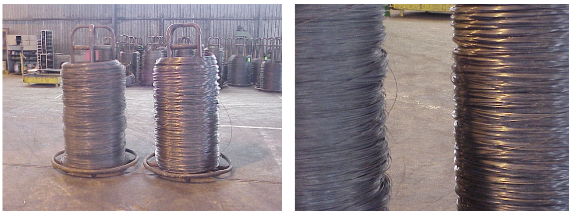
Figura 12 – Fotos Ilustrando a Diferença entre Arame com Baixa Camada Residual (à direita nas fotos) e Arame com Camada Residual Maior.
