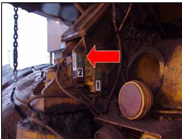
Figura 30 - Sensor de Corte de Óleo em Piso Desnivelado FONTE: U&M (2008)
